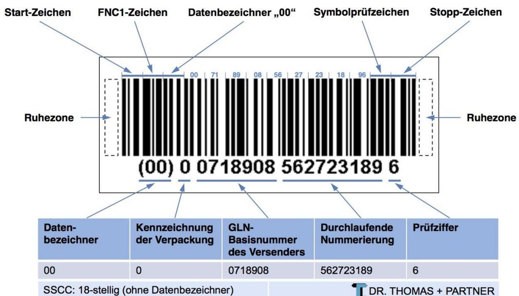
**Abbildung 3.5: Codeaufbau und Beschreibung eines SSCC (GS1-128)**
